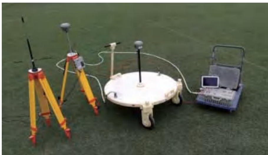
拖曳式高分辨率瞬变电磁仪
