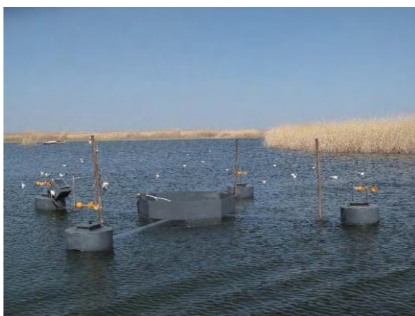
基于开放式浮船的漂浮式水面蒸发平台
