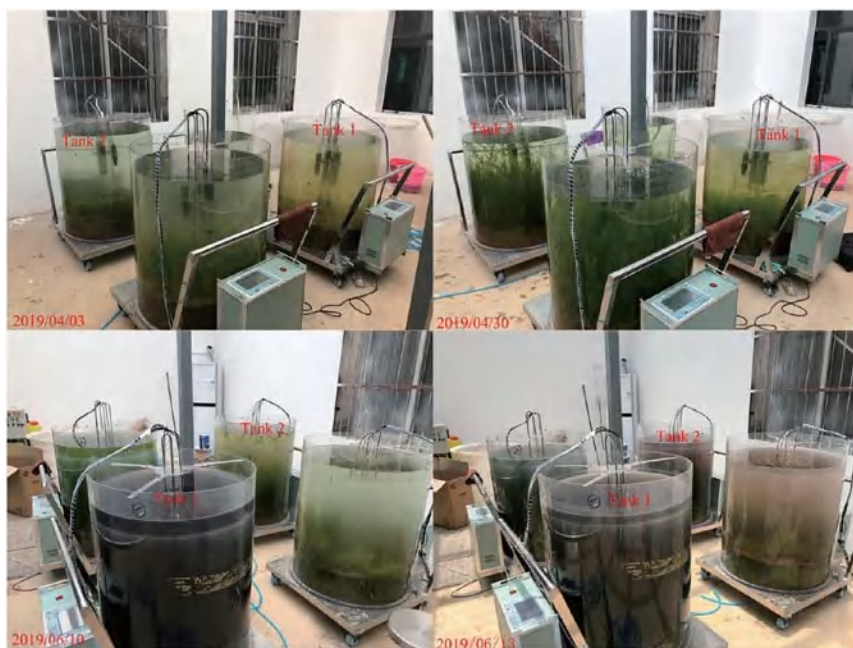
浮游植物为主的湖泊水生态系统模拟 (Tank1) 和大型水生植物为主的湖泊水生态系统模拟
