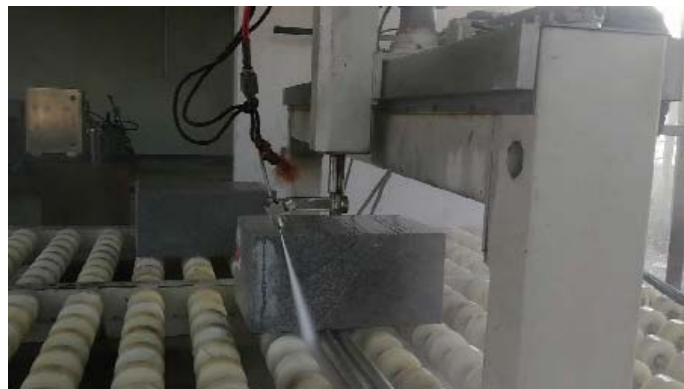
高压水切割试验
