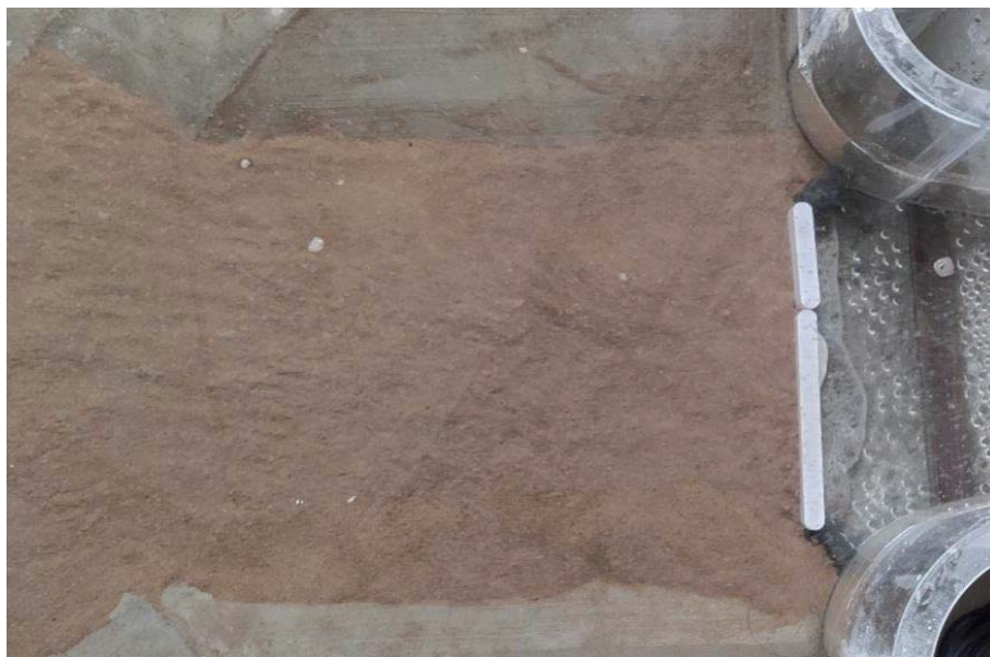
有拦沙坎时取水口口门泥沙运动情况
