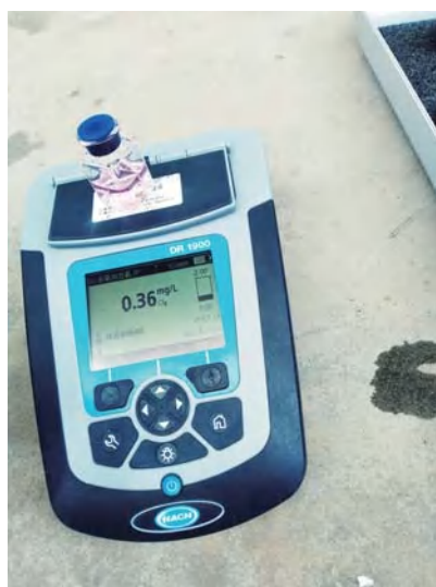
农饮工程出厂水消毒剂余量检测
