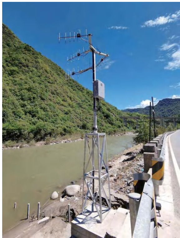
雷达侧扫测流仪在陕西汉中马道站的应用
